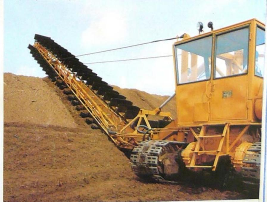
Штабелирование фрезерного торфа
