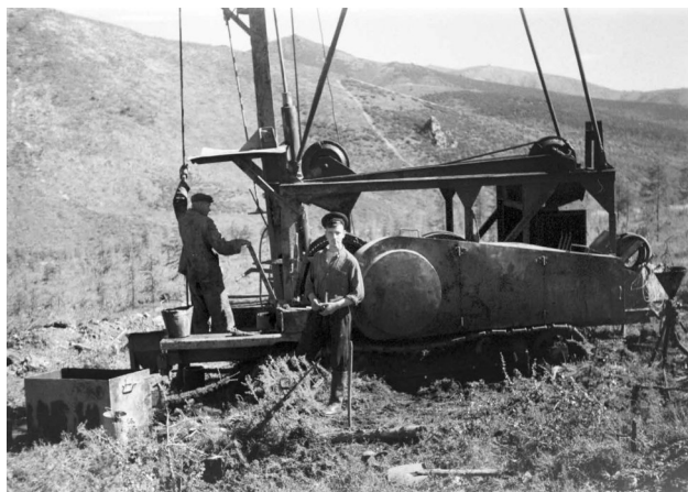
Буровой станок БУ-22М на разведке россыпи золота.
