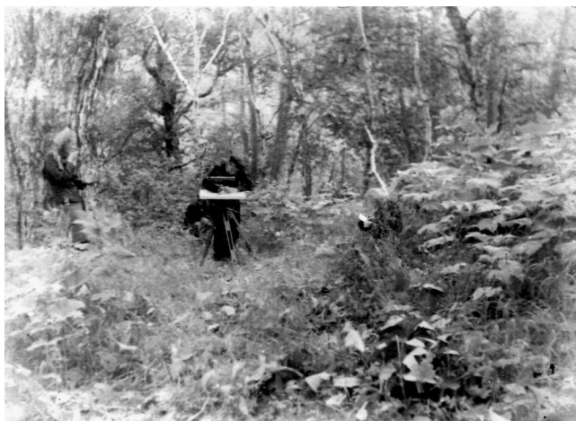
Работа с мензулой в долине р. Богачевки Фото из отчета Л.П. Грязнова, инв. № 143
