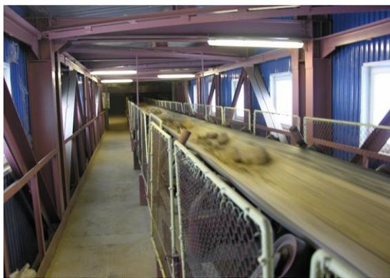
*Транспортировка руды из приемного бункера*
